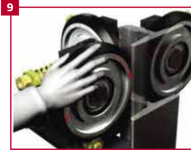
9 PATEN YAĞN MAKARALARI ELLE ÇEVİRİLDİĞİNDE RAHAATÇA DÖNÜYORSA UYGUN AYARLANMIŞ DEMEKTİR
