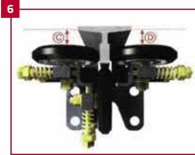
6 RAY VE MAKARALARIN MESAFELERİ C VE D ÖLÇÜSÜNDE BELİRTİLDİĞİ GİBİ EŞİT VE 0.25 mm OLMALIDIR
