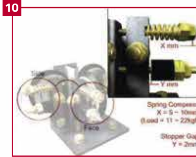
10 CİVATA ÜZERİNDEKİ YAYA BASTIRARAK 5-10 mm CEVİRİN, BU YAYIN SIKIŞMASINI SAĞLAYACAKTIR. PATEN GÖVDESİ İLE TAKOZ ARASINDA 2 mm BOŞLUK KALMALIDIR
