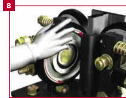
8 PATEN ARKA MAKARASI ELLE ÇEVİRİLDİĞİNDE RAHAATÇA DÖNÜYORSA UYGUN AYARLANMIŞ DEMEKTİR
