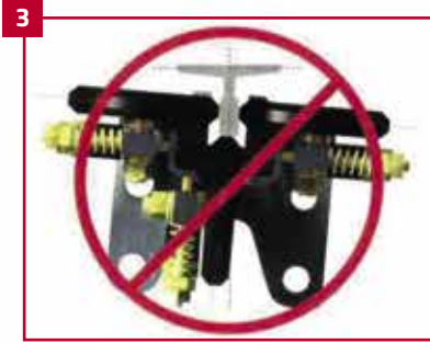
3 DÜZGÜN OLMAYAN HİZALAMADA PATEN SORUNLU ÇALIŞACAKTIR
