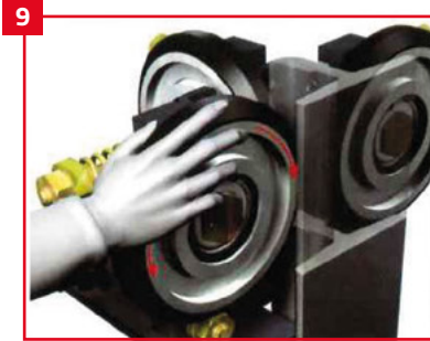
9 PATEN YAĞN MAKARALARI ELLE ÇEVİRİLDİĞİNDE RAHATÇA DÖNÜYORSA UYGUN AYARLANMIŞ DEMEKTİR IF SIDE ROLLER WHEEL SKID BY HAND, THE ADJUSTMENT IS SATISFACTORY
