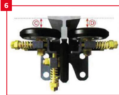
6 RAY VE MAKARALARIN MESAFELERİ C VE D ÖLÇÜSÜNDE BELİRTİLDİĞİ GİBİ EŞİT VE 0.25 mm OLMALIDIR CHECK THE DISTANCE FROM THE RAIL SIDE ROLLER WHEEL (C & D = LESS THAN 0.25 mm)
