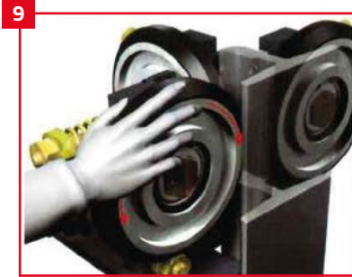
9 PATEN YAĞN MAKARALARI ELLE ÇEVİRİLDİĞİNDE RAHATÇA DÖNÜYÖRSE UYGUN AYARLANMIŞ DEMEKTİR IF SIDE ROLLER WHEEL SKID BY HAND, THE ADJUSTMENT IS SATISFACTORY
