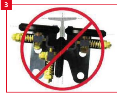
3 DÜZGÜN OLMAYAN HİZALAMADA PATEN SORUNLU ÇALIŞACAKTIR IMPROPER ALIGNMENT
